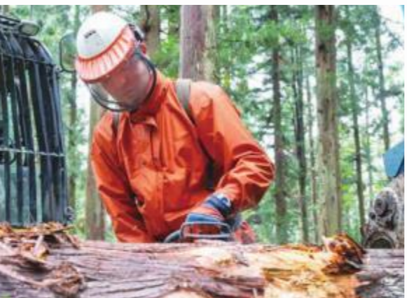
南魚沼市大倉地内の利用間伐現場。伐倒した木を重機でつかんだ状態のまま、計測を行い、チェーンソーで玉切りを行う荻原さん
